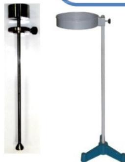
Piston taré et support trépied de l'appareil pour équivalent de sable
